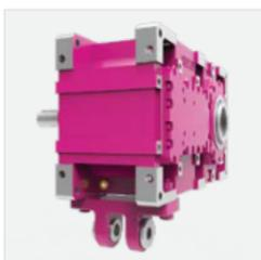
**Моментный рычаг** - предназначается для компенсации радиального биения валов во время работы, а так же теплового расширения узлов оборудования. Моментный рычаг крепится прямо к редуктору и может работать как на растяжение, так и на сжатие. Для компенсации нагрузок используется соединительный стержень с двумя шарнирными узлами, обеспечивающими достаточный боковой и радиальный люфт.
