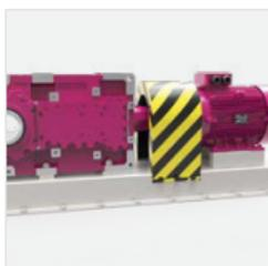
**Платформа привода VT** - мы предлагаем комплексное решение - на стальную раму (платформу) монтируется редуктор серии VT с присоединенным к нему электродвигателем на лапах и установленной между ними предохранительной проскальзывающей муфтой с защитным кожухом.
