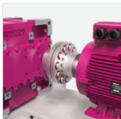
**Предохранительная проскальзывающая муфта** RUFLEX, используется для защиты от перегрузок при передаче крутящего момента между валами. При действии перегрузки муфта проскальзывает, и вращение выходного вала прекращается. Соединение валов восстанавливается автоматически без прекращения передачи момента при проскальзывании.
