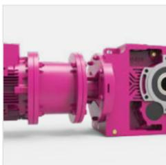
**Центробежный тормоз** - устанавливается в качестве дополнительного тормоза между электродвигателем и редуктором, в качестве дополнительных мер безопасности. Используется совместно с электромагнитным тормозом двигателя. Он останавливает электродвигатель в случае отказа главного тормоза.
