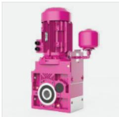
**Расширительный бак для масла** - предназначен для сброса избыточного давления и предотвращения утечки масла через сальники, во время работы редуктора. Это обусловлено тем, что в некоторых монтажных положениях есть необходимость практически полностью заполнить внутреннее пространство редуктора маслом, для оптимальной смазки всех ступеней.
