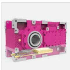
**Водяное охлаждение редуктора** - охлаждение осуществляется посредством холодной воды, протекающей через медные трубки, в виде змеевика, расположенные внутри корпуса редуктора и погруженные в трансмиссионное масло. Этот тип охлаждения используется в редукторах серии Н и В в монтажной позиции М1. должность.
