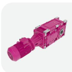
**VK** - коническо-цилиндрические горизонтальные мотор-редукторы с полым тихоходным и полым быстроходным валами под шпоночное соединение. Цельный быстроходный вал комплектуется специальным фланцем под электродвигатель IEC B5. Укомплектованы электродвигателем.
