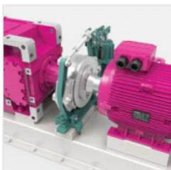
**Обгонная муфта** - это механическое устройство, основная задача которого – предотвращение передачи крутящего момента к ведущему валу от ведомого в моменты, когда ведомый вал начинает вращаться более быстро. Муфта также используется в тех случаях, когда необходимо передать крутящий момент лишь в одну сторону.
