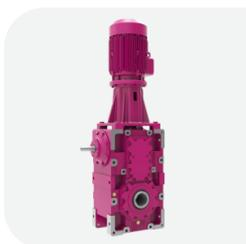
**VT.20** - коническо-цилиндрические горизонтальные мотор-редукторы с полым тихоходным и двумя быстроходным валами под шпоночное соединение, один из которых комплектуется специальным фланцем под электродвигатель IEC B5. Укомплектованы электродвигателем.
