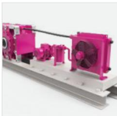
**Воздушно-масляный радиатор** - охлаждение трансмиссионного масла осуществляется воздушным потоком, от независимого электрического вентилятора, проходящим через теплообменник с насосом. Система монтируется вместе с редуктором на стальной раме. Подходит для условий работы при температурах ниже  $-40^{\circ}\text{C}$ . Данный способ охлаждения не применим в пыльных условиях.
