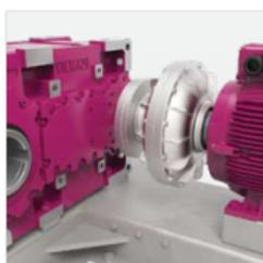
**Предохранительная гидродинамическая муфта** - способная в режимах пуска и торможения ограничивать заданным значением крутящий момент. Является эффективным быстродействующим средством защиты от недопустимых перегрузок двигателя и механической передачи. Обладая свойствами демпфирования и гашения крутильных колебаний, пульсирующих и пиковых нагрузок, гидромуфта позволяет увеличить срок службы оборудования.
